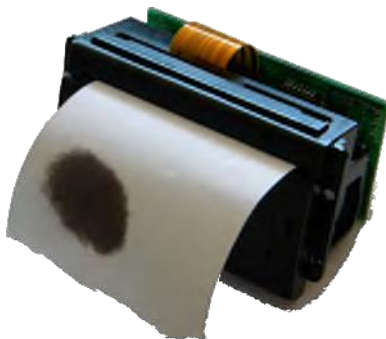
Рисунок 15: Нагретая термочувствительная сторона
